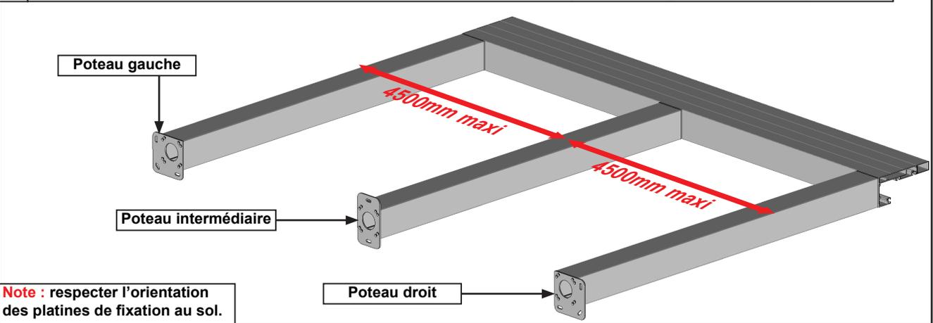
**Note :** respecter l'orientation des platines de fixation au sol.
