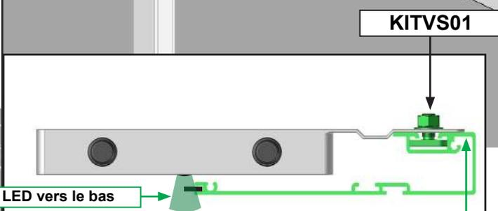
**Note :** réalisez une découpe sur le joint présent sur le PPV75 au niveau des LED
