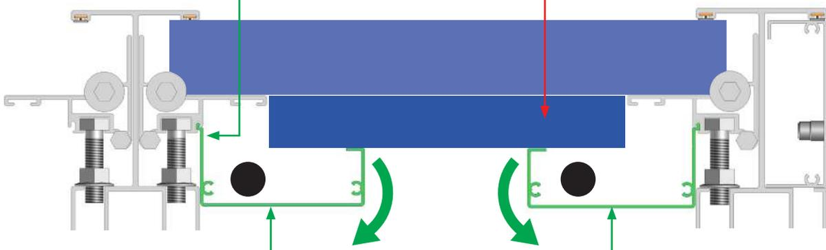
**Astuce :** exercez une légère flexion aux profils gouttière latéraux afin de positionner le profil gouttière inter panneau PV.
