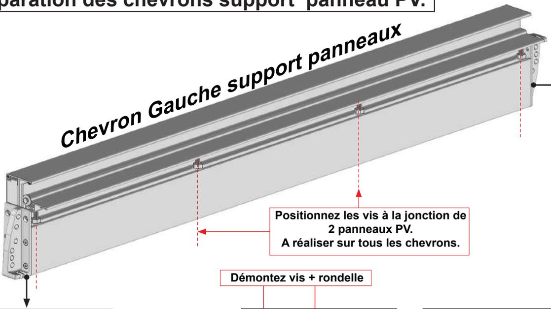
Positionnez les vis à la jonction de 2 panneaux PV.
