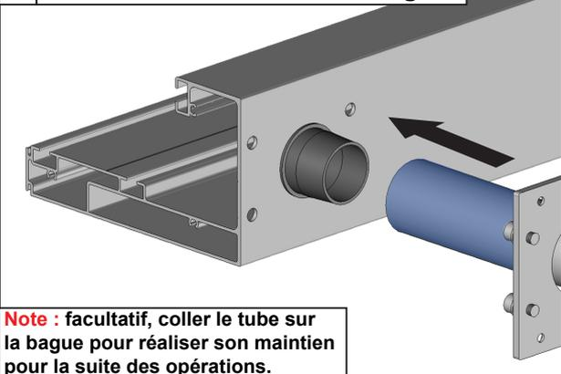
**Note :** facultatif, coller le tube sur la bague pour réaliser son maintien pour la suite des opérations.
