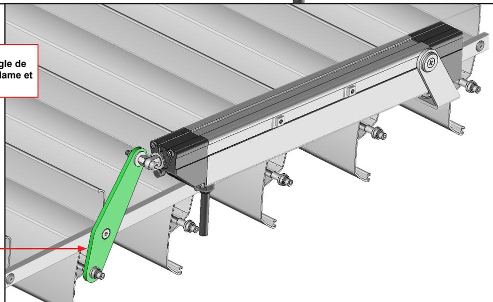
20 Pose de la tringle de manœuvre côté droit. Fixation lames ouvertes.
