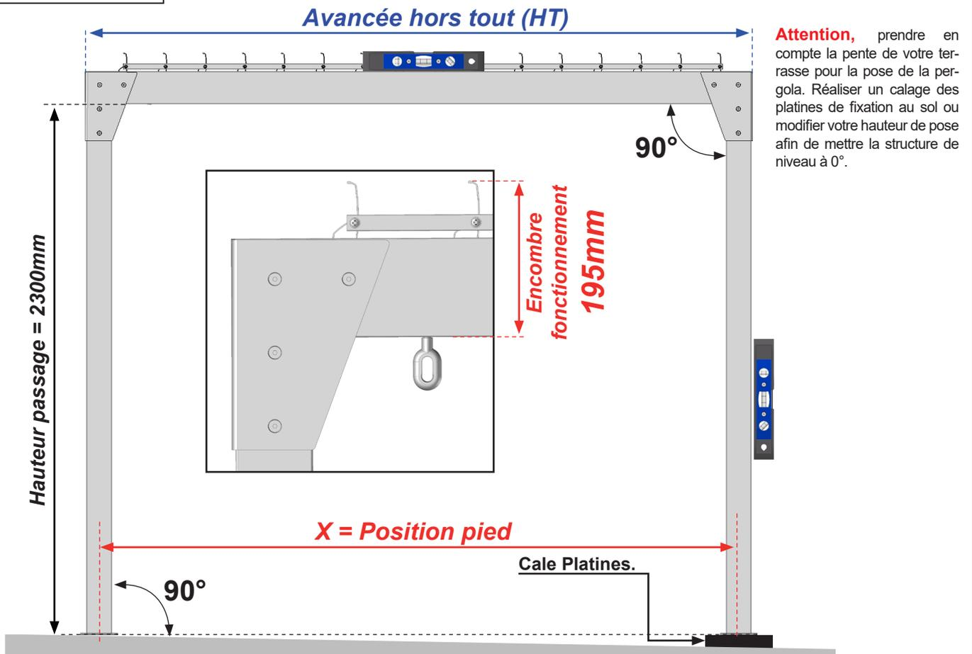
**Attention,** prendre en compte la pente de votre terrasse pour la pose de la pergola. Réaliser un calage des platines de fixation au sol ou modifier votre hauteur de pose afin de mettre la structure de niveau à 0°.
