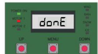
**IMPORTANT,** après la configuration du temps de travail, assurez-vous que les lames soient de niveau ( tablier bien a plat ). Dans le cas contraire desserrer les vis du BSO4202, et refaire la configuration du temps de travail vérin en position de départ zéro. ( Totalement fermée )
