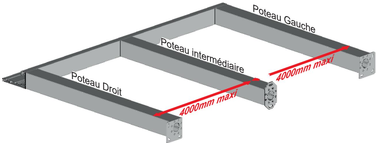
**Note :** respecter l'orientation des platines de fixation au sol.
