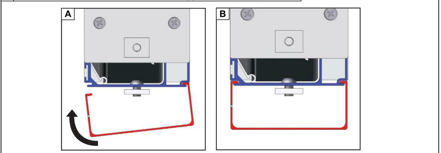
29 Pose du profil de finition profil mural entre les chevrons support de lames.
