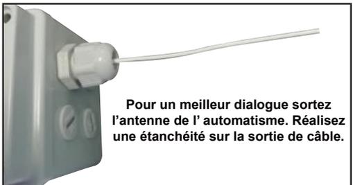
Pour un meilleur dialogue sortez l'antenne de l'automatisme. Réalisez une étanchéité sur la sortie de câble.
