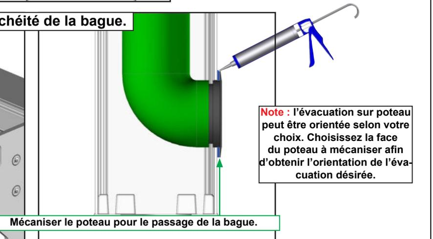
**Note :** l'évacuation sur poteau peut être orientée selon votre choix. Choisissez la face du poteau à mécaniser afin d'obtenir l'orientation de l'évacuation désirée.
