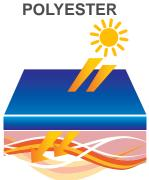
Très sensible aux UV Mauvaise tenue dans le temps Bonne résistance à la déchirure Imputrescible
