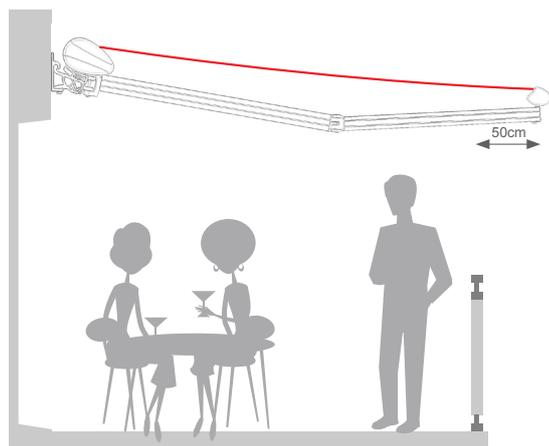
Dans le cas d'une pose sur un balcon il est préconisé une avancée du store banne supérieure de 50 cm afin de profiter pleinement de la surface de votre balcon.
