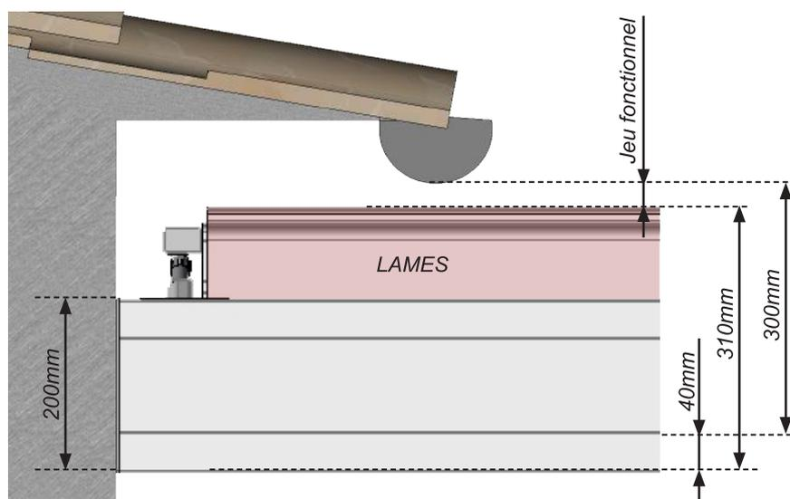
Contrôlez le positionnement des supports muraux (dans le cas de volets roulants traditionnels attention de ne pas tomber sur le caisson)
