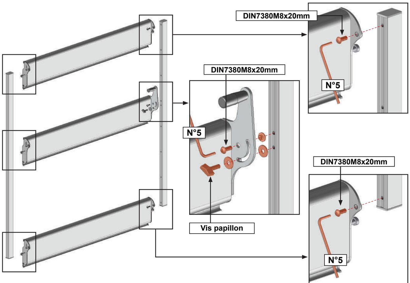
6 Ouvrir les lames à 45° et verrouiller la position à l'aide de la vis papillon.
