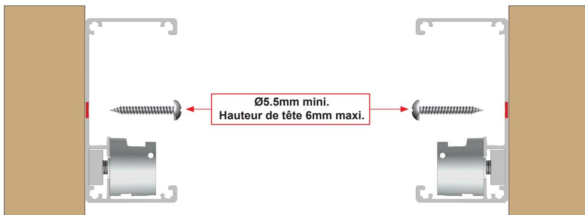
Adapter la fixation à la nature du mur. Kit de vis et rondelle non fournis. Dans le cas d'installation à l'aide d'un kit de scellement chimique, se référer aux instructions d'utilisation du produit utilisé.
