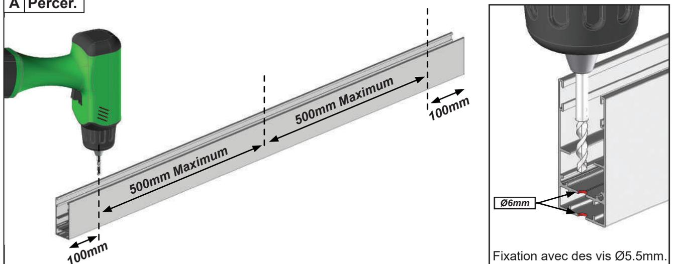
Ajuster le nombre de perçage en fonction de la longueur de la coulisse. Entre axe de 500mm maximum entre les perçages.
