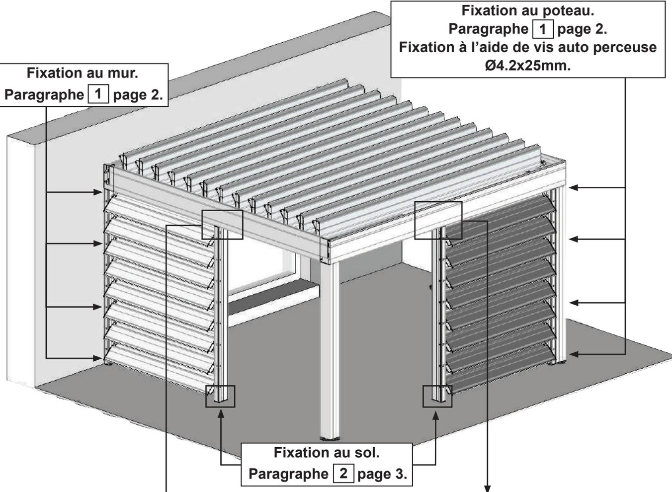
Répéter les opérations du paragraphe 2 page 3. Mais réaliser la fixation du montant sur le CELUX03 à l'aide d'écrou à sertir M8 INOX A2 + vis M8x20 + rondelles non fourni.
