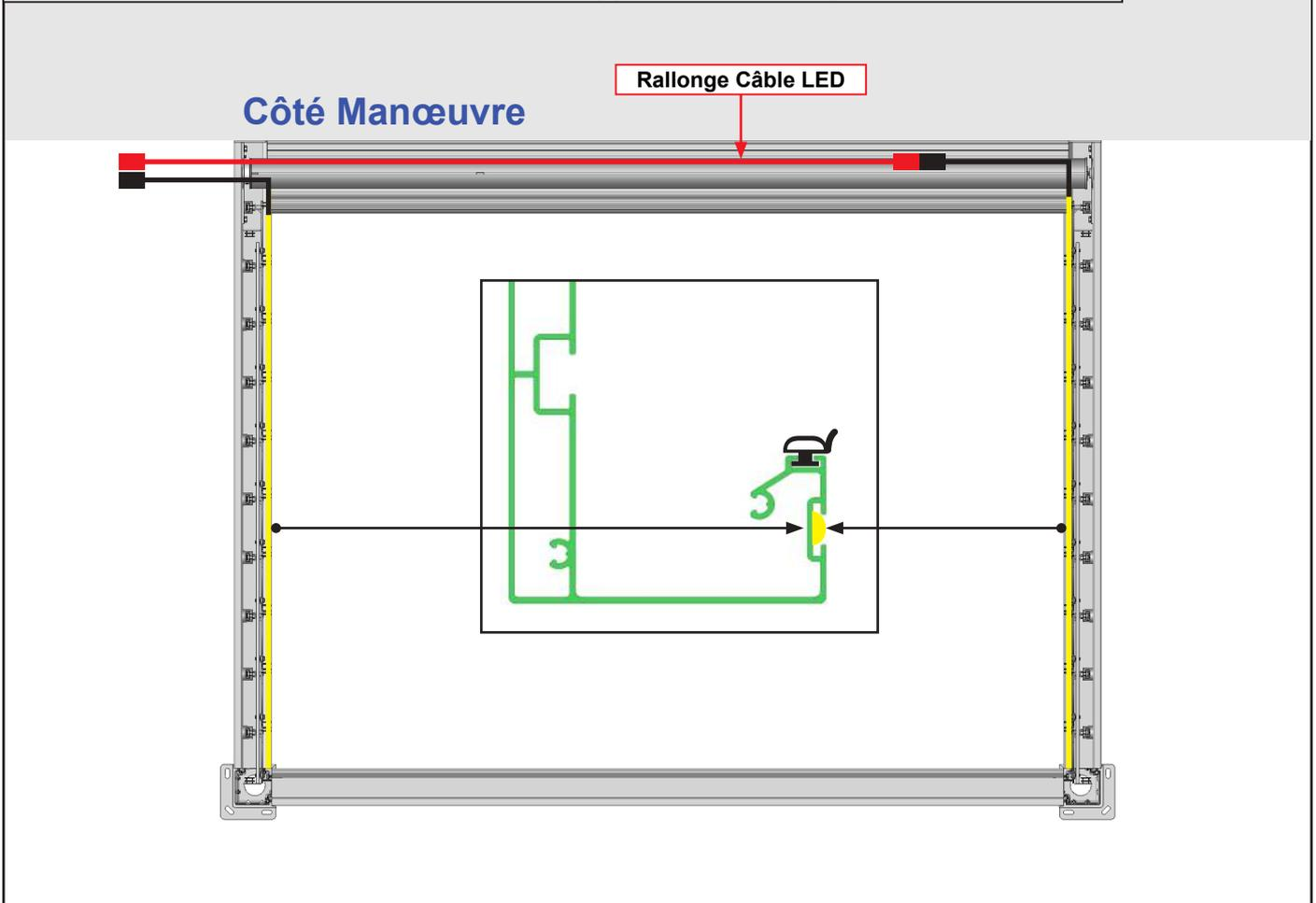
Pose des rubans de LED sur le coffre avant. Option LED seulement.
