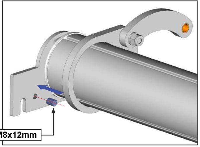
16 Pose du tube de manœuvre. Version treuil.
