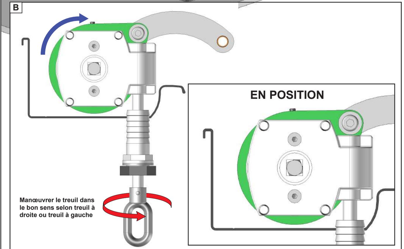
18 Pose du tube de manœuvre. Version Moteur.
