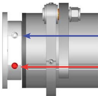
Vis de réglage ouverture des lames
