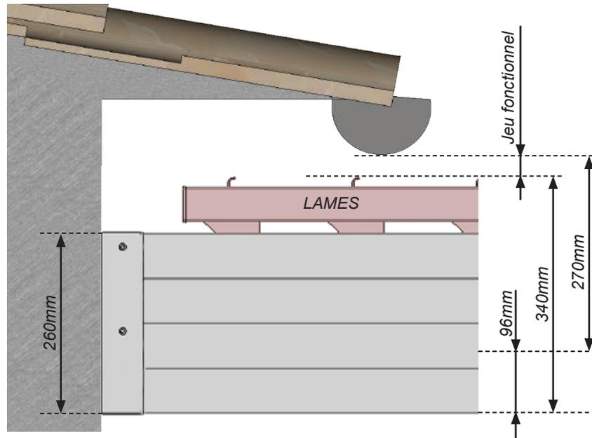
Contrôlez le positionnement des supports muraux (dans le cas de volets roulants traditionnels attention de ne pas tomber sur le caisson)
