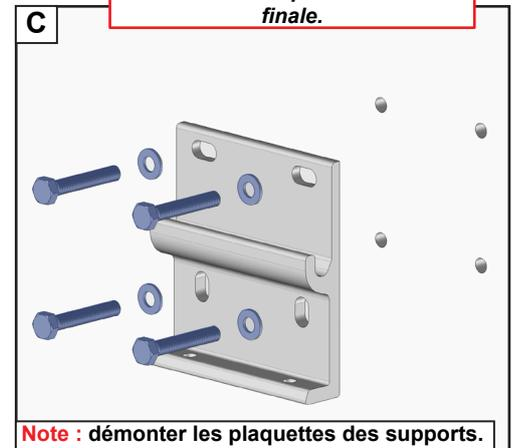
Adaptez la fixation à la nature du mur. Fixation avec des vis Ø10mm. Kit de vis et rondelles non fournis. Dans le cas d'installation à l'aide d'un kit de scellement chimique, se référer aux instructions d'utilisation du produit utilisé.
