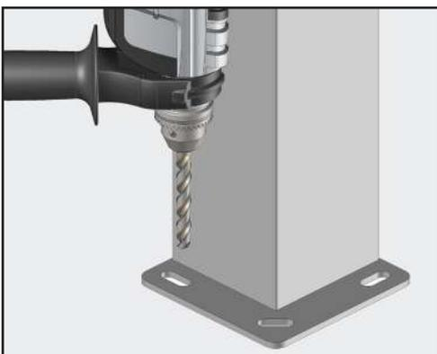
Fixez les platines au niveau de chaque plot béton réalisé auparavant.
