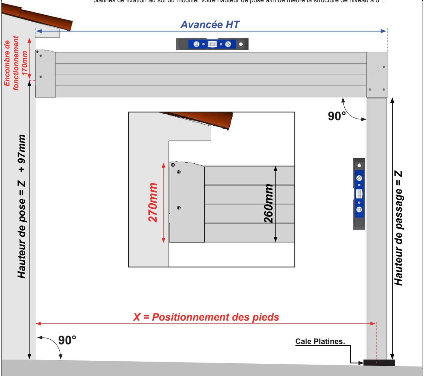
**$X = \text{Positionnement des pieds} = \text{avancée HT} - 60\text{mm}$**
