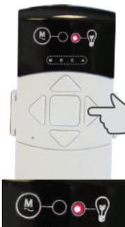
1 - Appuyer sur droite pour sélectionner le canal des LED
