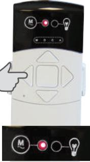
1 - Appuyer sur gauche pour sélectionner le canal du moteur
