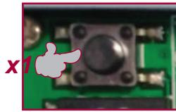
2 - Appuyer sur la touche SEL de l'AUTOMOWIND3D01. L'indicateur LED clignote et légère rotation du moteur.
