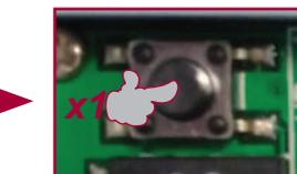
2 - Appuyer sur la touche SEL de l'AUTOMOWIND3D01. L'indicateur LED clignote et légère rotation du moteur.
