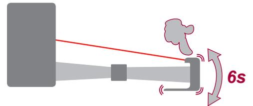
3 - Secouer la barre de la charge du store pendant 6 secondes. Vérifier que le store se ferme au-delà de ce délai. Contrôler si l'amplitude des secousses est suffisante ou non. Dans le cas contraire régler le sélecteur sur une autre position.
