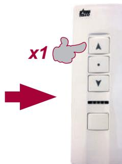
3 - Appuyer sur MONTÉE une fois dans un intervalle de 10s. Légère rotation du moteur.
