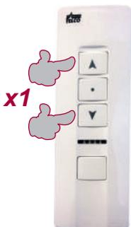
1 - Appuyer sur MONTÉE et DESCENTE simultanément.
