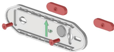
Fixer le socle à l'aide des vis et des plaquettes fournies sur la barre de charge de votre store. Attention respecter le positionnement du socle et de la position du SWITCH de la carte électronique, selon la fixation choisie.
