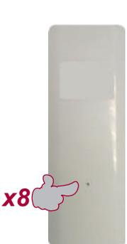
1 - Appuyer 8 fois sur le bouton d'apprentissage au dos de la télécommande. Légère rotation du moteur.
