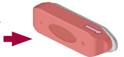
2 - Clipper le boîtier sur le socle fixé sur la barre de charge.
