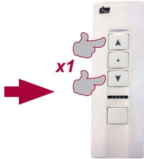
2 - Appuyer sur MONTÉE et DESCENTE simultanément.
