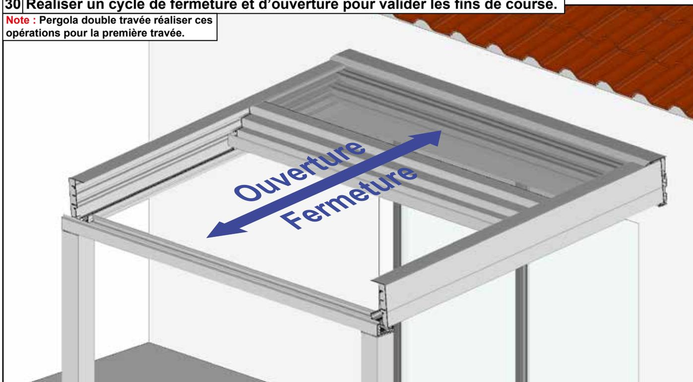
**Pergola double travée :** réaliser la pose de la seconde travée. Reprendre le montage à partir de l'opération 13 page 16.
