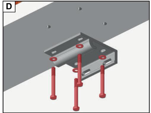
Adapter la fixation à la nature du mur. Fixation avec des vis Ø10mm. Kit de vis et rondelles non fourni. Dans le cas d'installation à l'aide d'un kit de scellement chimique, se référer aux instructions d'utilisation du produit utilisé.
