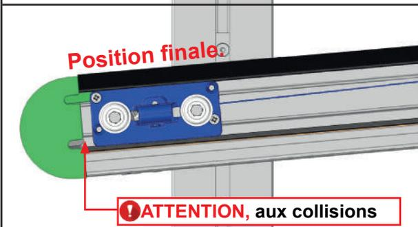
5 - Actionner la vis de fin de course ouverture selon votre configuration pour ajuster l'ouverture de la toile. En position finale la barre de charge coulissante doit entrer dans la barre de charge frontale.
