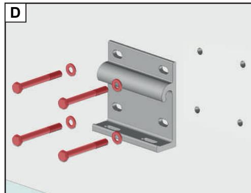
Adapter la fixation à la nature du mur. Fixation avec des vis Ø10mm. Kit de vis et rondelles non fourni. Dans le cas d'installation à l'aide d'un kit de scellement chimique, se référer aux instructions d'utilisation du produit utilisé.
