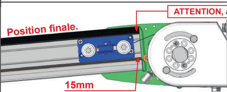
2 - Actionner la vis de fin de course fermeture selon votre configuration afin de positionner la barre de charge coulissante en position finale.
