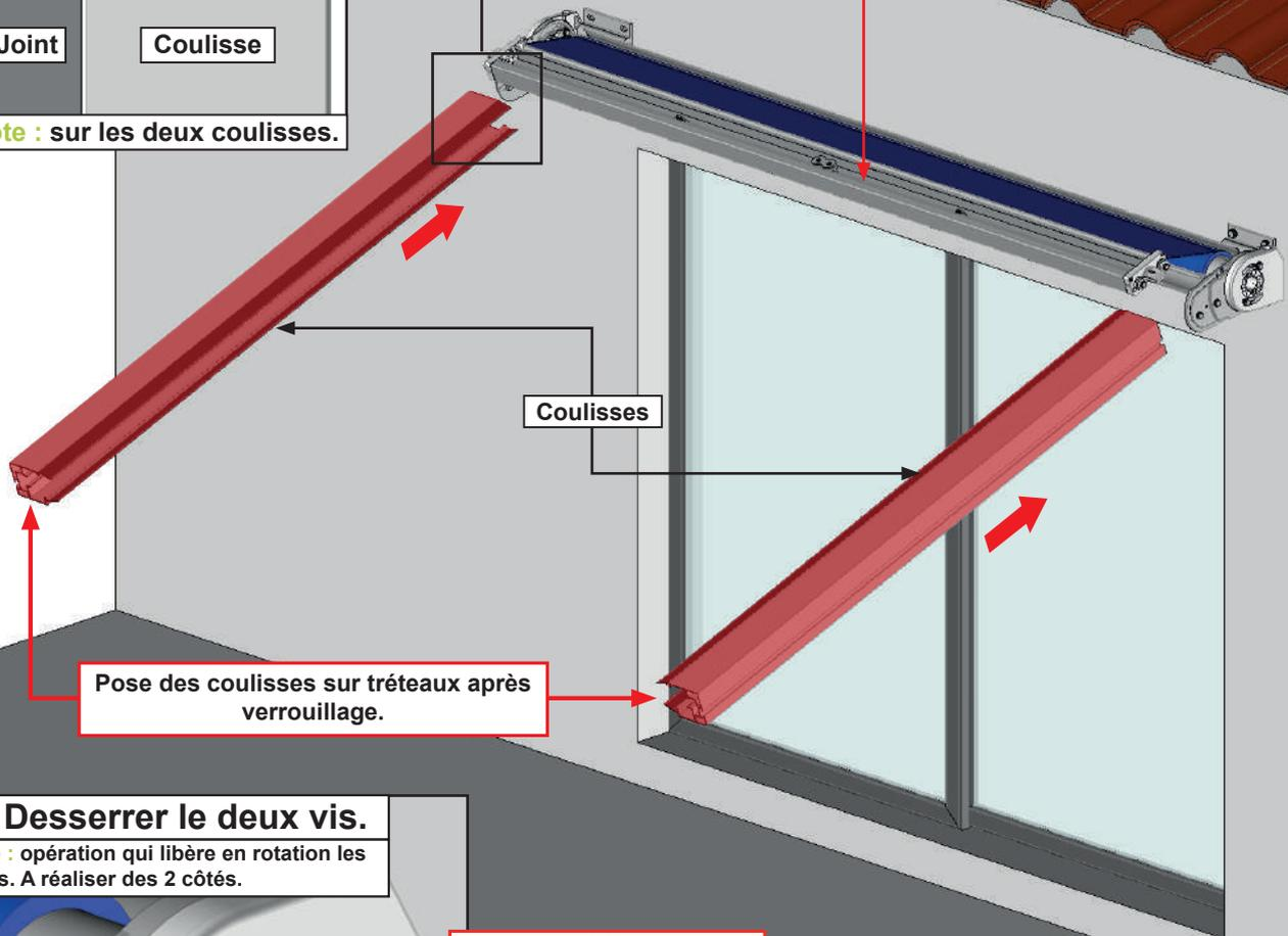
Pose des coulisses sur tréteaux après verrouillage.
