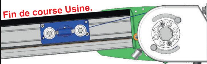
1 - Fermer la toile jusqu'à la butée de fermeture pré réglée en usine.
