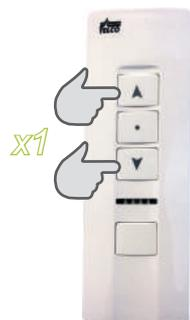
1 - Appuyer sur MONTÉE et DESCENTE simultanément.
