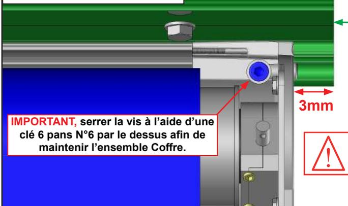
**IMPORTANT,** serrer la vis à l'aide d'une clé 6 pans N°6 par le dessus afin de maintenir l'ensemble Coffre.
