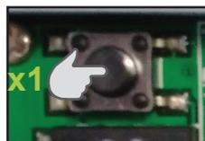
2 - Appuyer sur la touche SEL de l'AUTOMOWIND3D01. L'indicateur LED clignote et légère rotation du moteur.
