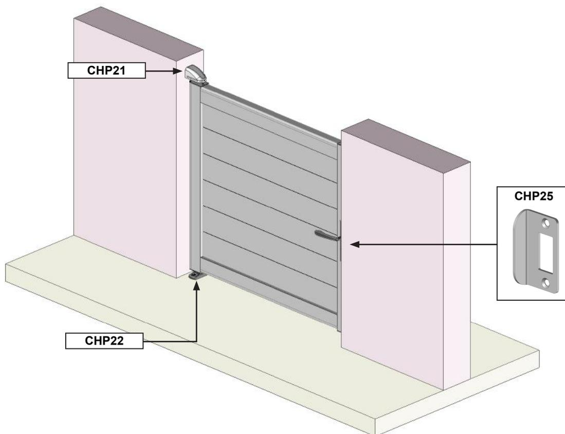
Contrôlez le niveau et la planéité des murs et du sol. Dans le cas de mauvais niveaux ou défaut de planéité, réaliser les opérations nécessaires afin de réajustez l'ensemble.
