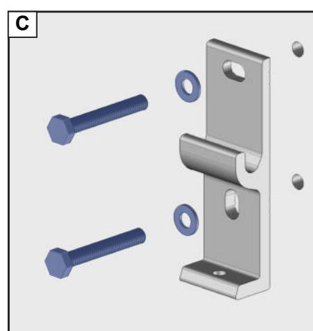
**Adapter la fixation à la nature du mur. Fixation avec des vis Ø10mm. Kit de vis et rondelle non fournis. Dans le cas d'installation à l'aide d'un kit de scellement chimique, se référer aux instructions d'utilisation du produit utilisé.**
