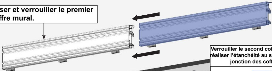
Verrouiller le second coffre mural et réaliser l'étanchéité au silicone de la jonction des coffres.
