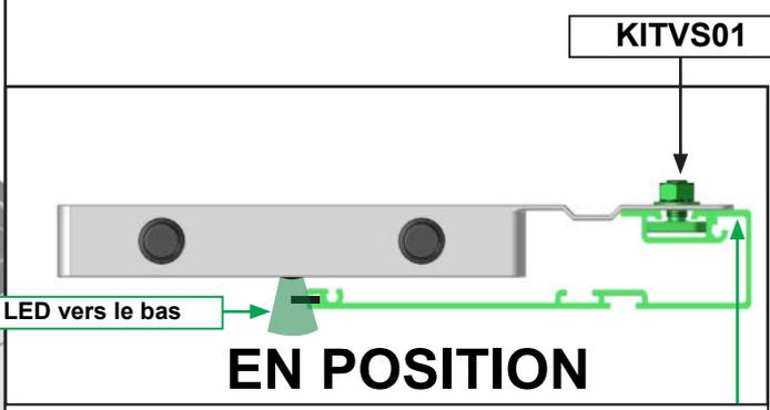
**Note :** réalisez une découpe sur le joint présent sur le PPV75 au niveau des LED
