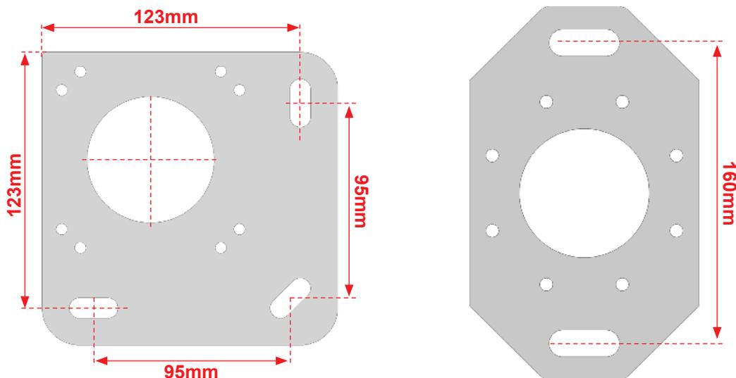
Fixez les platines au niveau de chaque plot béton réalisé auparavant par deux vis minimum.
