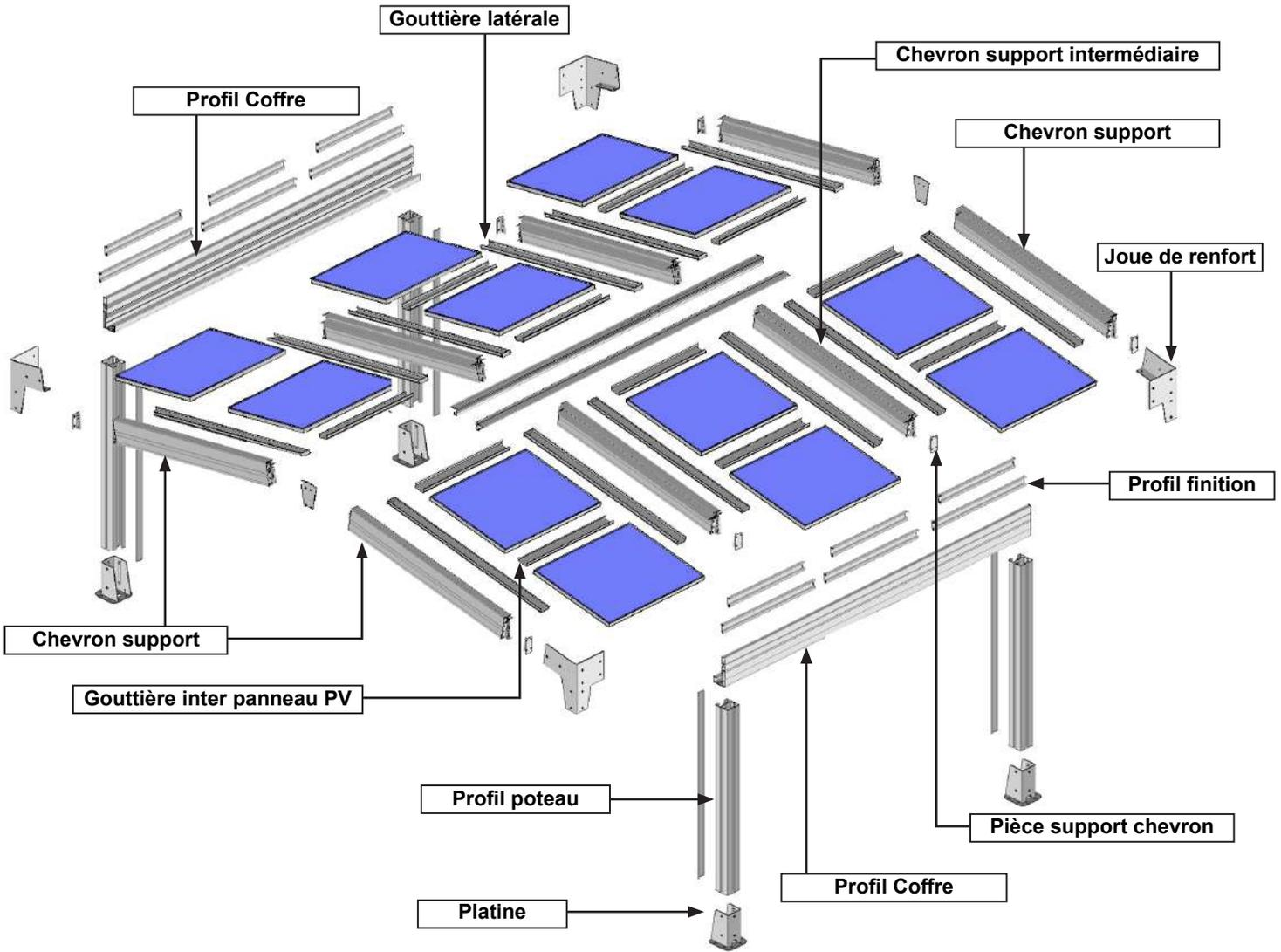
Les Ensembles prémontés en usine. Éclatés page 37 et 38.
