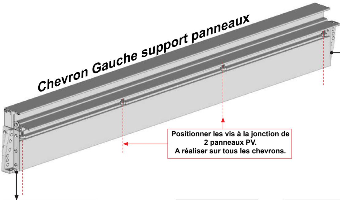
Positionner les vis à la jonction de 2 panneaux PV.
