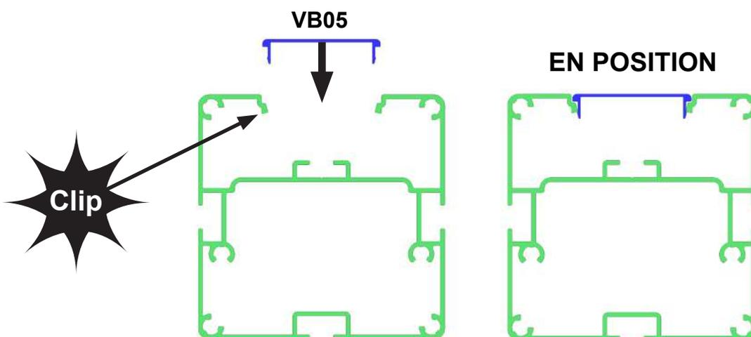
Clipper les profils de finition PPV64 entre chaque chevron support panneau PV.
