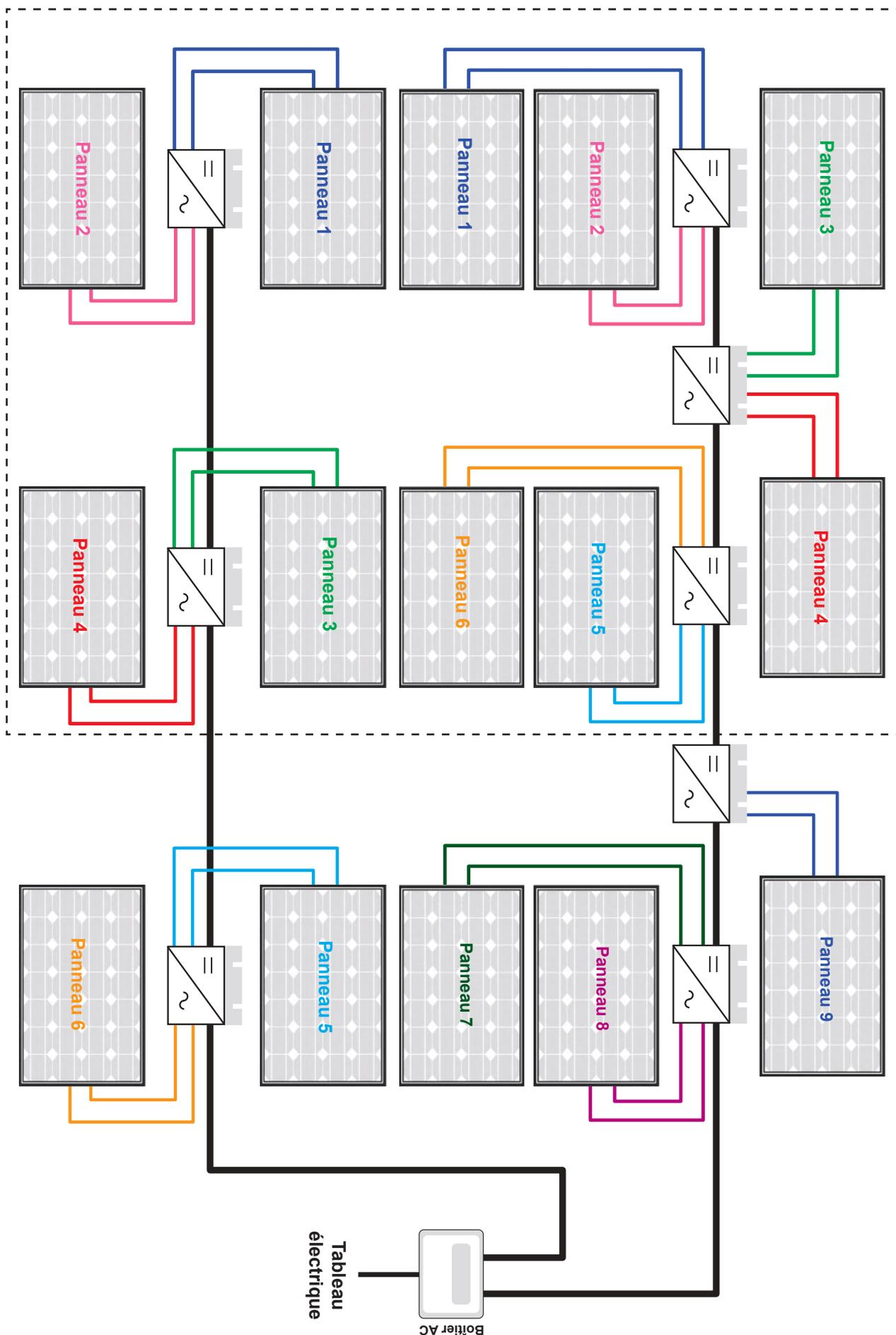
Schémas de principe 6KW : **ATTENTION**, connectez 5 micro-onduleurs maximum par entrée du boîtier AC 6 KW.
