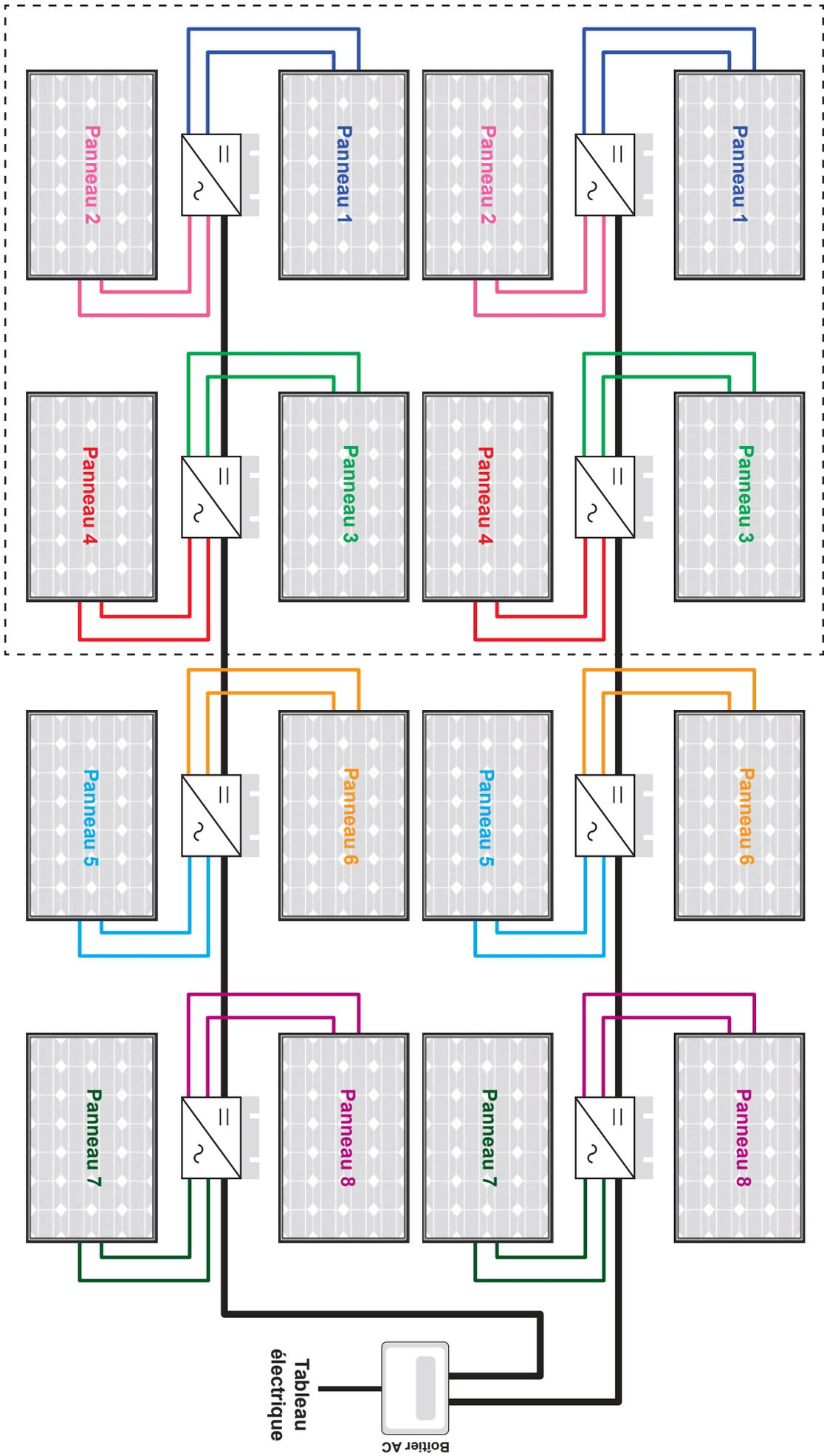
Schémas de principe 6KW : **ATTENTION**, équilibrez le nombre de micro-onduleur par entrée du boîtier AC 6 KW. Maxi 5 MO par entrée AC.
